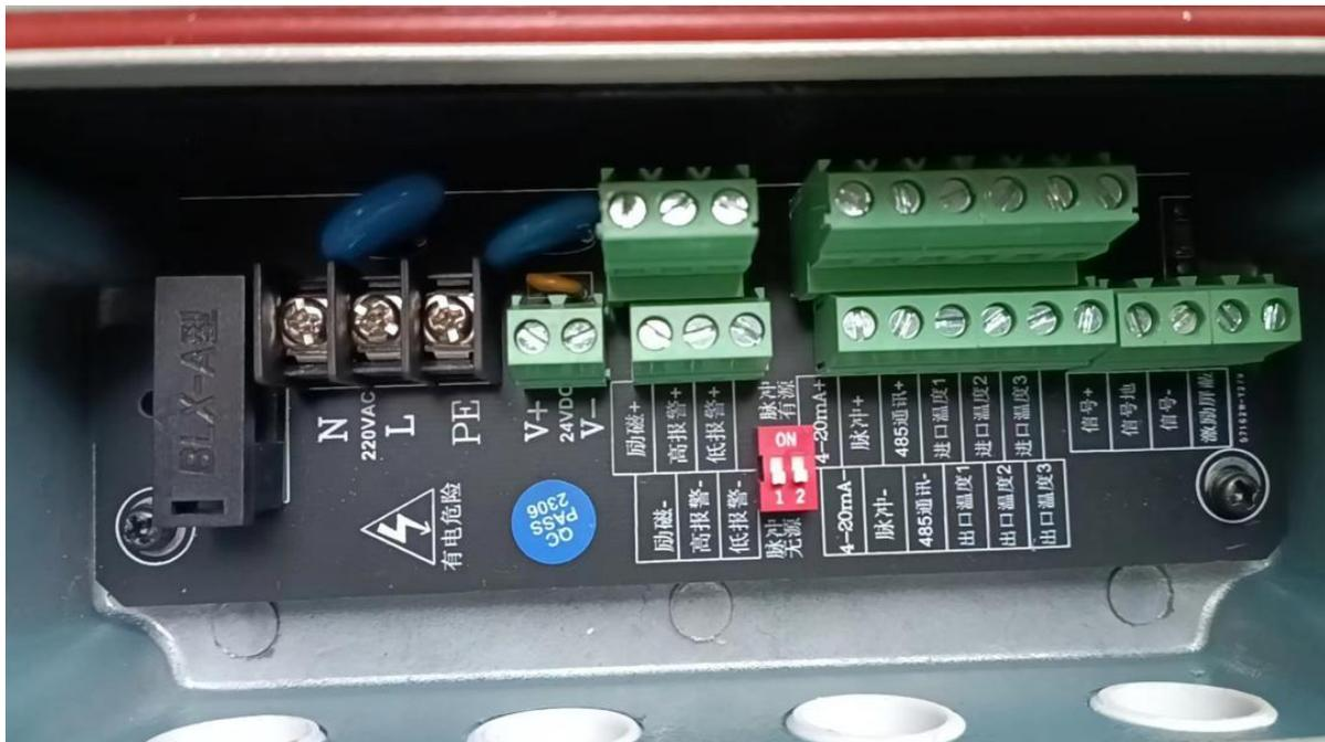
每台热量表是2个热电偶，一个是进水一个是出水。每个热电偶有3根线，黄色的线接到温度1，剩下的2根线可以任意的接温度2和3。
