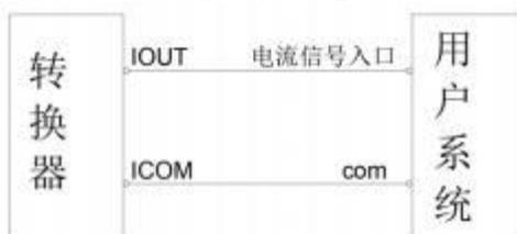
**注意：模拟电流输出为有源输出，不能外接电源。**
